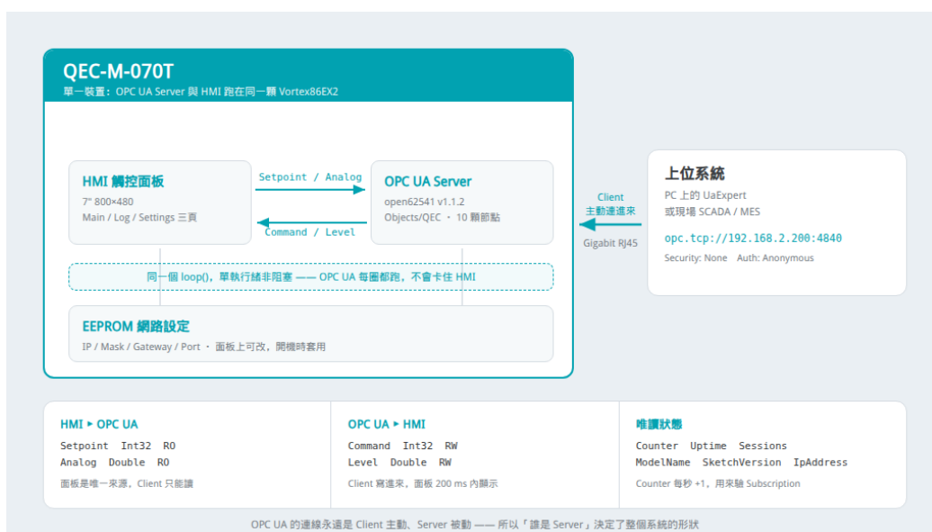
圖 1-1 系統架構與資料流：上位系統以 Client 身分連進 QEC，而 HMI 面板、OPC UA Server 與設定區都跑在同一顆 Vortex86EX2 上。
